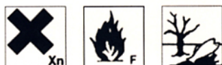
Slika 2 Bencin je zelo hlapen. Njegovi hlapi so v zmesi z zrakom vnetljivi. Je škodljiv za zdravje ljudi pri vdihavanju in v stiku s kožo ter škodljiv za okolje. Hranimo ga izven dosega otrok ter ločeno od virov vžiga.
