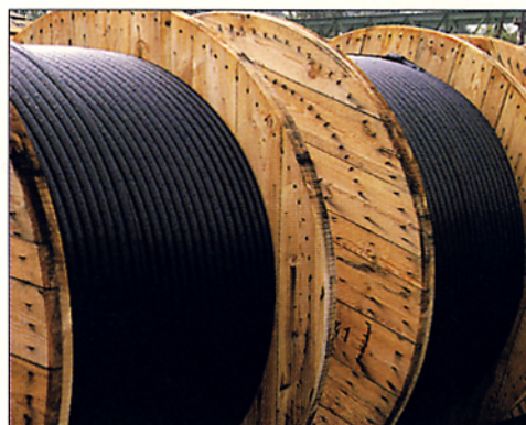
Slika 4 Električni kabli so izolirani s polivinilkloridom.
