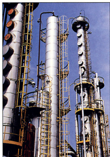
Slika 5 Pri destilaciji surove nafte dobimo v posamezni frakciji zmes ogljikovodikov s podobnim vreliščem.
