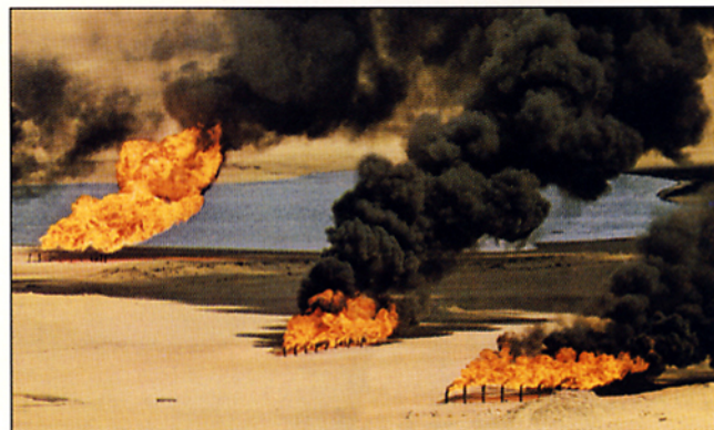
Slika 3 Gorenje plinastih ogljikovodikov pri črpanju nafte. Na naftnih poljih gorijo plinasti ogljikovodiki iz surove nafte. Teh plinov ne zbirajo, ker so stroški zbiranja, skladiščenja in transporta previsoki in ne bi bili pokriti s prodajo. Če pa je plina dovolj, ga uporabijo na črpalnišču za pogon strojev.
